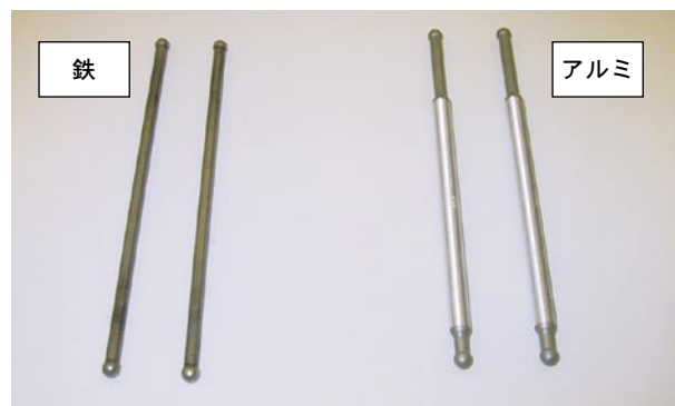
図5 プッシュロッドのアルミ化
