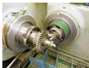
図9 噛合わせ検査による歯当り評価
