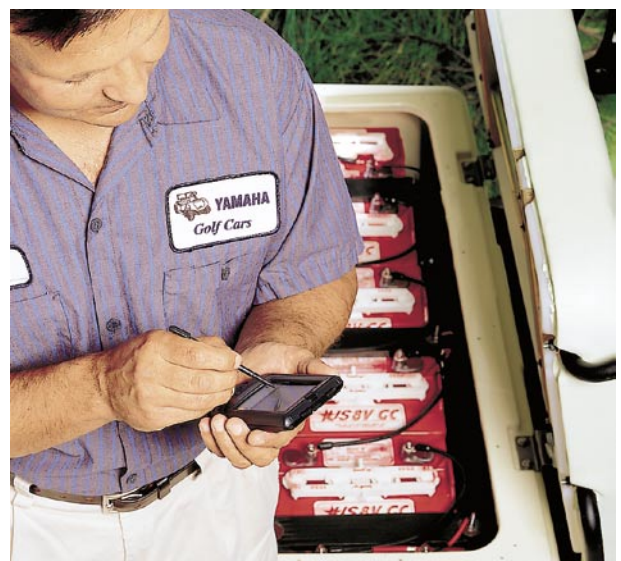
図11 PDAによるMCUとの通信
