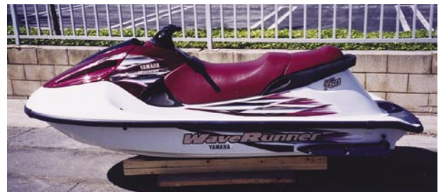
図 19 軽量 SMC 採用の GP760 生産艇
