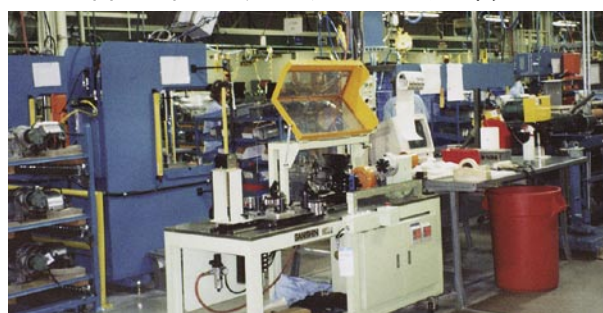
図 18 YMMC に設置されたジェットポンプ組み立てライン
