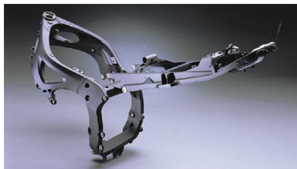
図 5 ダイキャスト製デルタボックスⅢフレーム
