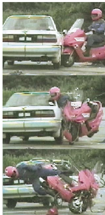
図1 二輪車対四輪車の衝突試験の様子
