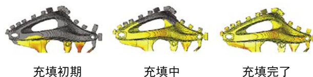
図 4 リアアーム鑄造シミュレーション
