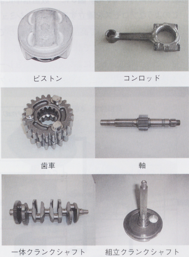
図 1 二輪車の主な鍛造部品
