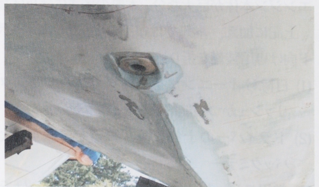
図7 貫通ピースのリセス形状 (ブリ評価での造り込み写真)
