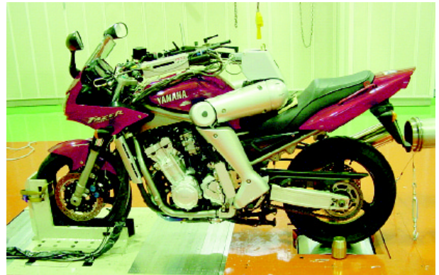
図1 ロボットを使用したモータサイクルの評価
