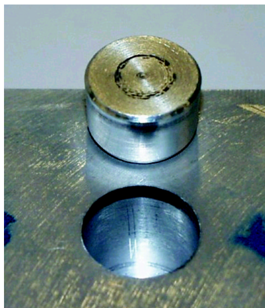
図6 圧入後に取り外したテーパープラグと穴 (カジリは見られない)
