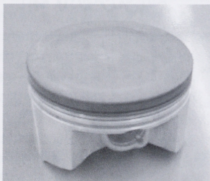
図10 高硬度陽極酸化処理ピストン外観
