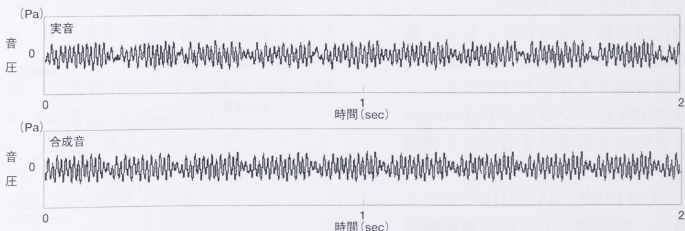
図9 実音と合成音の比較(アイドリング音)
