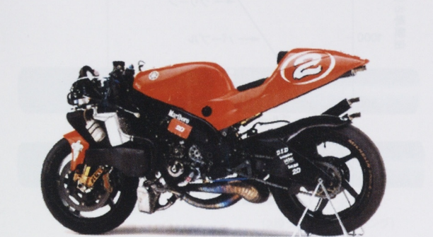
図3 レース車のチタンマフラ
