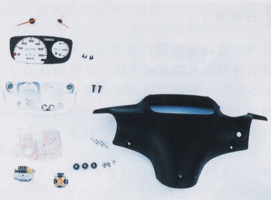
(1) 従来モデルの部品構成
