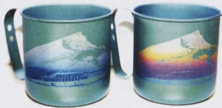
図7 陽極酸化法による着色の実用例
