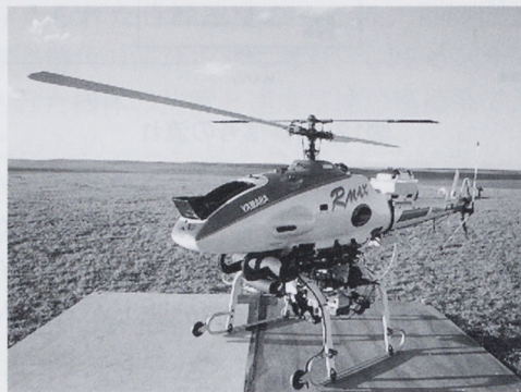
図15 計測装置を搭載した自律無人ヘリ
