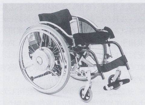
図2 JW-IIを装着した車イス
