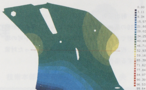
図10 充填完了時の圧力分布
