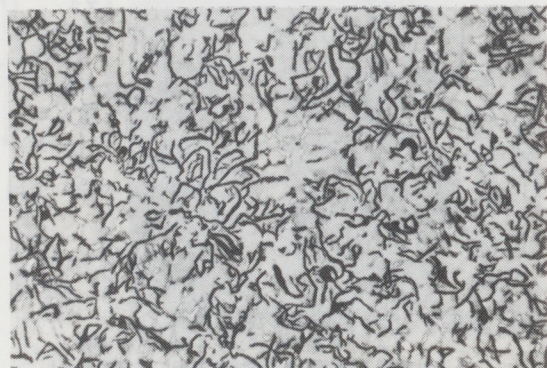
図9 シリンダーライナー素材組織。白色部は微細ステダイト、黒色部はA型片状黒鉛、マトリクスはパーライト。
