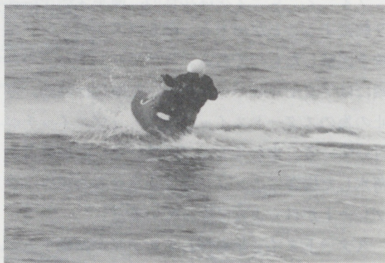
写真3 プロトタイプの試運転風景(筆者) スピニングをさせながら逆ハンを切り旋回径を縮める。
