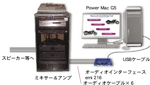
図4 二輪車サウンドデザインツールの構成
