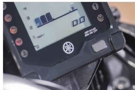
Fig. 8 ABS switch on meter
