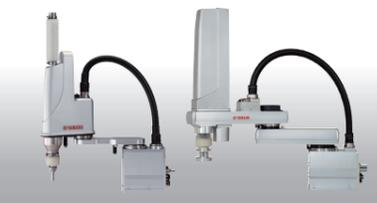
防塵防濺品種最適合水、灰塵多的作業環境(相當於防護等級IP65)
