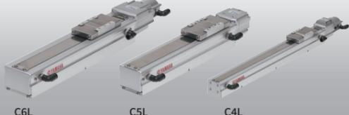
「FLIP-X系列」的無塵室規格。從輕量精簡的機型到最大有效荷重120kg的大型機型，可依據用途選購14款機型。標準配備吸氣用空氣接頭，潤滑油採用低壓潤滑油，滑台面配備耐用性優異的不鏽鋼板，達成了高度的無塵等級。
