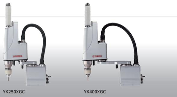
使用低磨性組件的防塵套覆蓋住Z軸的花鍵部，完全密封住其他的滑動部分。線束也是完全內置，從底座背面進行機器人內部的吸氣，可以防止引起粉塵。
