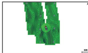
緑色の丸は適切な深度および GPS 位置、ならびに 16 km/h (10 mph) を下回る速度を示します。黄色の丸は適切な深度および GPS 位置、ならびに 16~32 km/h (10~20 mph) の速度を示します。赤色の丸は適切でない深度または GPS 位置、ならびに 32 km/h (20 mph) を上回る速度を示します。
