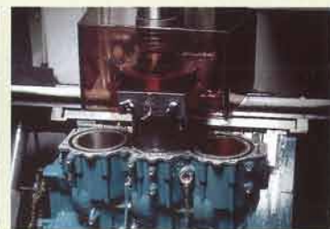
Engine blocks and connecting rods are processed with micron accuracy. Los bloques de motor y varillas de conexión se fabrican con precisión micrométrica.
