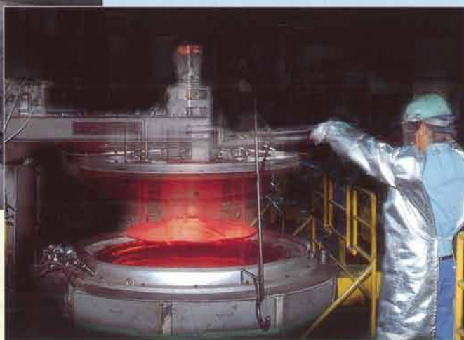
Vital engine parts like crank shafts go from oven to salt bath twice in Yamaha's double tempering process for extra hardness. Las piezas importantes del motor como los cigüeñales se endurecen aún más pasando dos veces del horno al baño de sales en el doble proceso de revenido de Yamaha.
