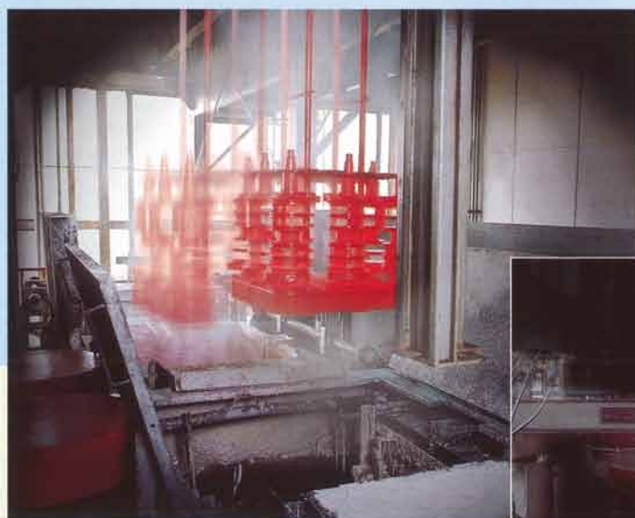
Vital engine parts like crank shafts go from oven to salt bath twice in Yamaha's double tempering process for extra hardness. Las piezas importantes del motor como los cigüeñales se endurecen aún más pasando dos veces del horno al baño de sales en el doble proceso de revenido de Yamaha.
