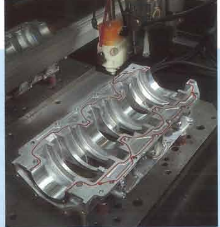
Liquid gaskets are used to achieve high-precision fit. Las juntas líquidas se usan para conseguir ajustes de alta precisión.
