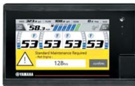
时间间隔的提醒功能还配备了频率的自定义功能,按需求可以设定50、100、300、400、500或1000个小时。充分利用此功能,就能够在最佳的时间段内对船外机及其他设备实施检查。
