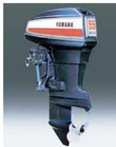
55A成为雅马哈进入大马力类别的基础。它的液冷双缸760cc发动机具有多项独特技术，例如完全渗碳的一体式曲轴箱，2件式连杆等。
