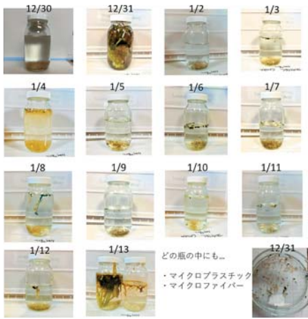
Les objets prélevés à l'aide du filet neuston sont classés par date. Les microplastiques flottent dans la partie supérieure de la bouteille. Ce n'est pas visible à l'œil nu, mais les microfibrilles en font également partie.
