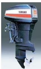
Le 55A devint le modèle de base pour les grands formats. Le moteur à deux cylindres de 760 cm 3 à refroidissement à eau incorpore des technologies particulières comme un vilebrequin monobloc à cémentation-trempe complète, une bielle en deux parties et bien plus encore.
