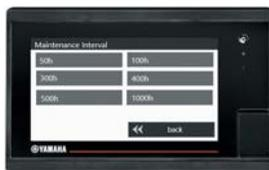
Es necesario insistir en la importancia del uso de esta función de avisos de mantenimiento. Gracias a ella, los usuarios pueden evitar pasar por alto inspecciones periódicas, con las que puede alargarse la vida del motor.
