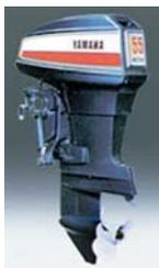
El 55A sirvió para que Yamaha se introdujera en la categoría de motores de elevados caballos de potencia. Su motor de 760 cc de dos cilindros con refrigeración líquida se basaba en tecnologías únicas, como un cárter de una pieza totalmente carbonizado, una biela conectora de dos piezas y mucho más.
