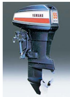
أصبحت 55A هي الأساس لانتقال ياماها إلى فئة القدرة الحصانية الكبيرة . محركه ذي ال 2 إسطوانة 760 سم مكعب بمبرد سائل يمتاز بالعديد من التقنيات الفريدة مثل علبة المرافق المكونة بالكامل من قطعة واحدة وقضبان التوصيل المكونة من قطعتين والمزيد .
