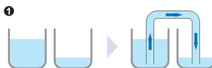
Dans deux récipients avec des niveaux d'eau distincts, en y insérant un tuyau rempli d'eau, l'eau s'écoule du récipient avec un niveau d'eau élevé vers le récipient avec un niveau d'eau faible.
