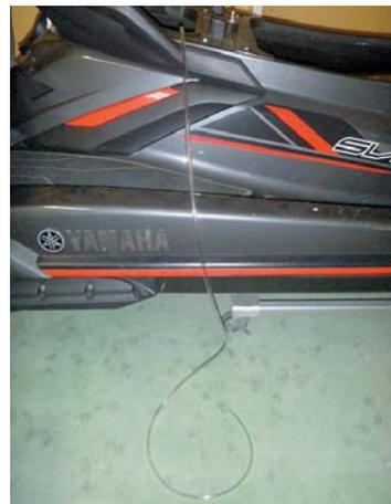
**4** Vierte agua del grifo en la parte de afuera de la manguera y, luego, el aire será empujado hacia afuera de la manguera y el tubo, dejando únicamente agua en su interior.
