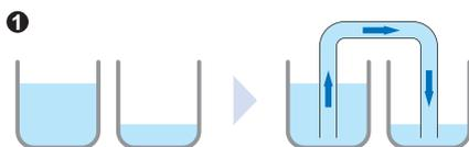
Cuando una manguera llena de agua se pone en dos contenedores con diferentes niveles de agua, el agua fluye del contenedor de agua con más alto nivel al otro con menos nivel de agua.
