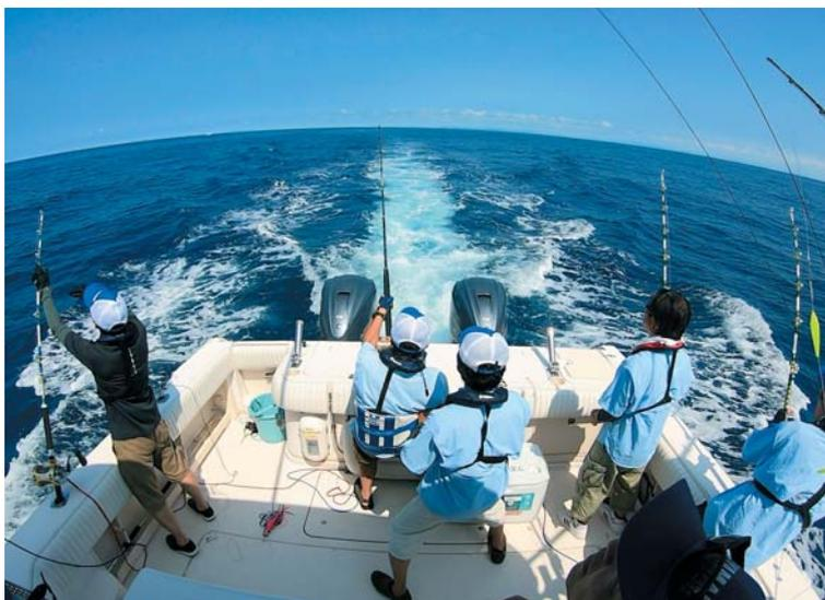
是在有波浪的外海,螺旋桨也不会打滑,而且还会产生强有力的推动力。拖钓1日时和以往的3台船外机相比,耗油量可以降低20%。另外,操控系统也得到了良好的改善。对于拖钓来讲,船外机操控系统的速度控制是最有效的功能。为了让鱼饵适应变化万千的海况,船速的调节需要达到精益求精的水准。只要轻轻按一下速度控制功能的按钮,即可以实现100rpm的微调,所以对拖钓是非常有效果的。明年也会有新的成员参加旗鱼大赛,我们都会站在用户的立场上来享受竞技钓鱼。
