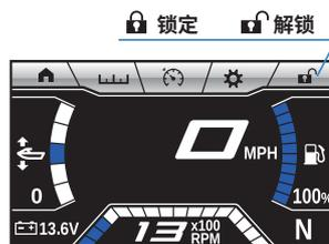
雅马哈的安全系统具有防止被他人擅自驾驶以及预防被偷盗的功能。如果选择安全系统的锁定模式,将无法启动引擎。
