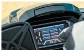
使用的是触屏式4.3英寸液晶多功能显示器,除了可以确认行驶状态以及发动机相关的各类信息之外,瞬间即可设定驱动控制和安全系统,便于操作。
