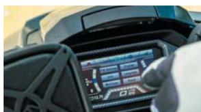
Utilisation d'un écran à cristaux liquides multifonction tactile de 4,3 pouces. Outre la vérification de diverses informations concernant le parcours et le moteur, vous pourrez aussi régler instantanément et intuitivement le contrôle de conduite et le système de sécurité.
