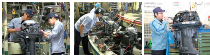
(Foto 2) Montaje: los productos se mueven por transportadores elevados
