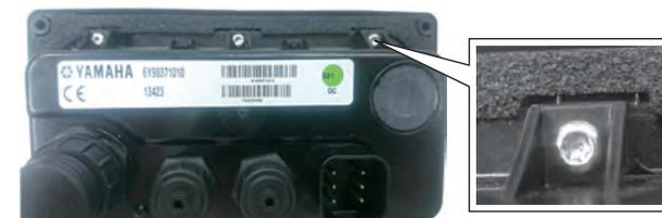
L'afficheur 6Y9 n'est cependant pas conçu pour être démonté lors des opérations de maintenance, et même si vous voyez ce type de vis, vous ne devez pas démonter ce composant sans permission ou instructions spéciales.
