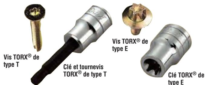
Inventées aux États-Unis en 1967, les vis TORX® sont très connues et utilisées à l'heure actuelle en tant que vis de sécurité. Le dessin des vis TORX® et des outils correspondants permet un bon engagement et un couple de vissage supérieur. Ces avantages, plus que la résistance au sabotage, ont fait que les vis TORX® sont devenues plus répandues que les vis cruciformes, en particulier en Europe. Si l'on veut, les vis de type T peuvent même être tournées avec un tournevis plat ordinaire.
