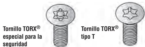
El tornillo de la izquierda es un tornillo TORX® especial para la seguridad. A diferencia del tornillo normal de tipo T, tiene una protuberancia en el centro, que impide aflojarlo a la fuerza con un destornillador plano de uso común. Sin embargo, en Japón se consigue fácilmente un destornillador apropiado para tornillos de este tipo, por lo que ya dejó de ser efectivo su papel como tornillo de seguridad.
