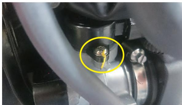
Cuando usted vea este tipo de tornillo, en principio significa que usted no debería desmontar el componente sin un permiso o instrucción especial.
