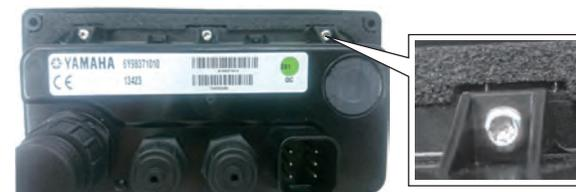
Sin embargo, el calibre 6Y9 es un componente que en general no se desmonta durante las tareas de mantenimiento, por lo tanto, aunque usted ve un tornillo de este tipo, no debe desmontar el componente sin permiso o instrucción especial.
