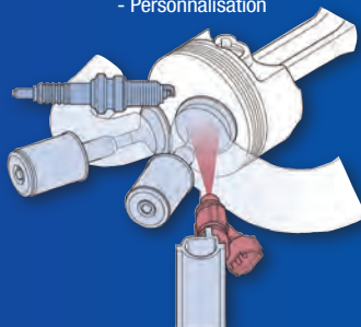
Injection de carburant sans batterie
