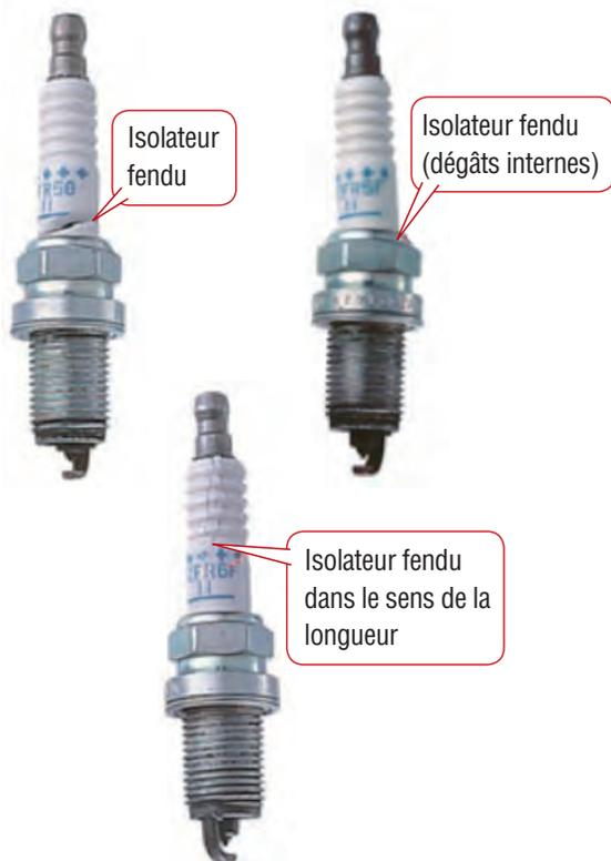
**Symptôme 2 :** Manque de puissance à haute vitesse ou avec des charges lourdes, pistons, soupapes ou cylindre endommagés
