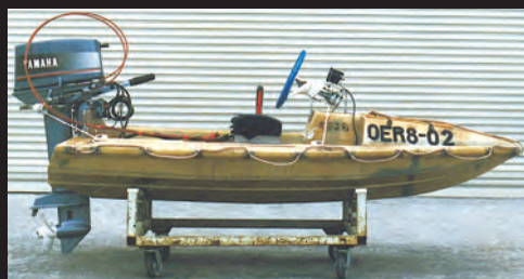
Модель Power Ski (вверху), опробованная в США в 1984 г., была оснащена подвесным мотором мощностью в 25 л.с.
