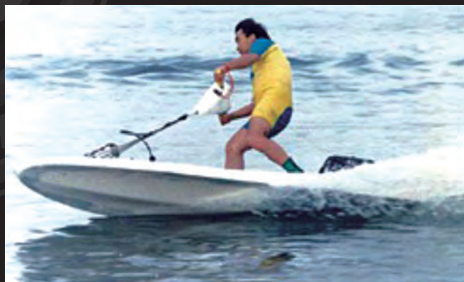
Модель Power Ski (вверху), опробованная в США в 1984 г., была оснащена подвесным мотором мощностью в 25 л.с.
