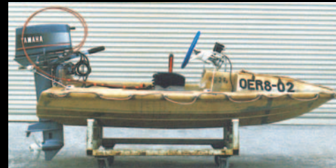
كان موديل النموذج التجريبي الخاص في "Power Ski" (في الأعلى) والذي تم اختباره في الولايات المتحدة في العام 1984 من طراز الوقوف والمجهز بمحرك خارجي ذو قدرة 25 حصان.
