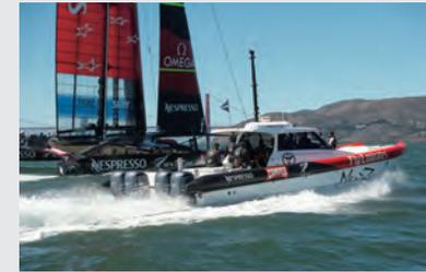
El barco de apoyo del ETNZ propulsado con 4 unidades del F300B de Yamaha logra una impresionante velocidad punta de 58 nudos (107 km/h).
