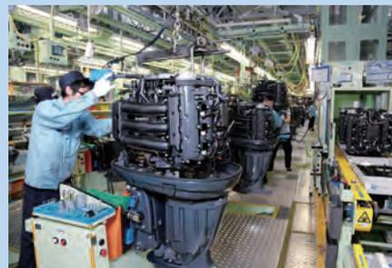
El proceso final de montaje. Aquí los componentes se juntan en las etapas de submontaje y luego se montan de acuerdo con cada especificación precisa de los numerosos modelos.
