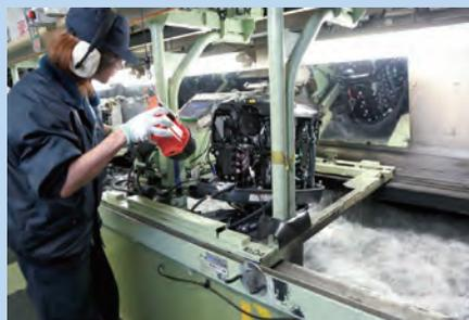
Todos los motores fueraborda de Yamaha pasan por el proceso de verificación una vez acabados.
