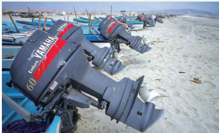
Yamaha détient près de 100 % du marché des hors-bord à usage commercial à Oman. Les principaux modèles vendus ici sont des deux-temps intermédiaires, comme les 40, 60, 75 et 85 ch.
