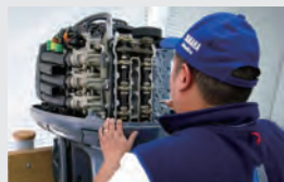
Un des tests pratiques consistait à démonter et remonter l'arbre à cames d'un F225A.
