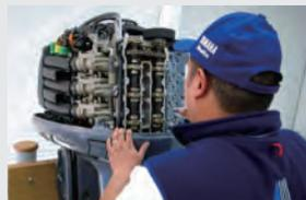
Una de las pruebas de prácticas consistió en desmontar y montar de nuevo el cigüeñal de un F225A.
