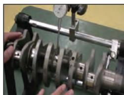
Monter le vilebrequin sur l'outil d'alignement de vilebrequin, et ajuster les rouleaux de l'outil d'alignement de manière que les deux paliers principaux à chaque extrémité de l'arbre reposent sur les rouleaux. Régler la jauge à cadran de manière à l'aligner avec le centre du palier principal. Ensuite, tourner lentement le vilebrequin pour mesurer le voile à l'aide de la jauge à cadran.
