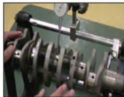
Se coloca el cigüeñal sobre el alineador asegurando que los dos cojinetes principales de ambos extremos del cigüeñal se sitúen sobre los rodillos del alineador.
