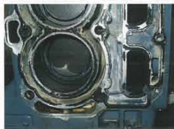
With flushing (after approx. 500 hrs. use) Avec détartrage (après env. 500 h d'utilisation)
