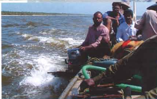
A unique outboard mount is used for fishing boats in Kerala with the bracket attached to the gunwale Las lanchas pesqueras de Kerala montan los fuerabordas de una manera muy especial: fijados a la borda
