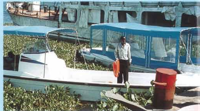
Yamaha FRP boat for water hyacinth gathering Lancha FRP Yamaha usada para recoger jacintos de agua
