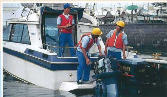
El Sr. Tomita (a la derecha) dirige los ensayos sobre el agua, registrando los resultados de la prueba de funcionamiento en diferentes condiciones del mar y en diferentes ángulos del asiento.
