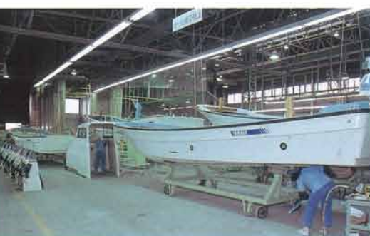
Boat production goes into its final process after hull/console assembly. Después del montaje de casco y consola, los buques pasan al proceso final de su fabricación.
