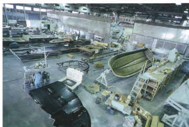
Hull assembly line. Línea de montaje de cascos/cubiertas
