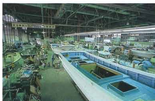
Hull/deck assembly line. Línea de montaje de cascos
