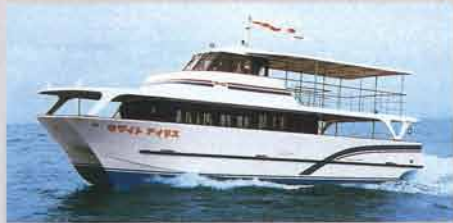
Twin-hulled high-speed boat "White Iris" "White Iris", la embarcación de pasajeros de dos cascos y de alta velocidad
