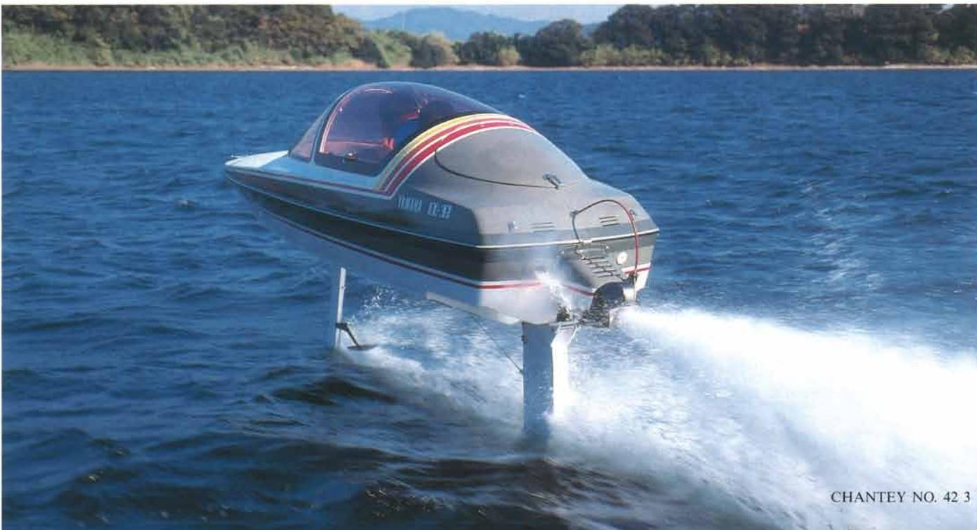
bateau hydrofoil perçant la surface de l'eau au niveau du confort de croisière.
