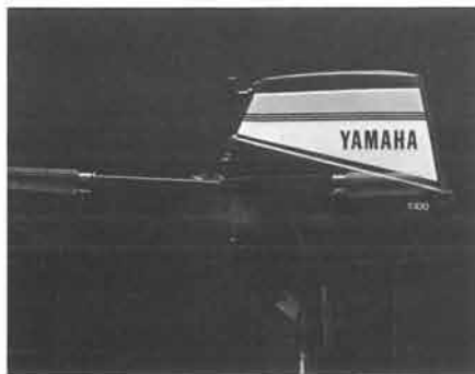
Fig. 1 180° fold-back steering handle Fig. 1 Asidero de dirección de 180 pliegues Fig. 1 Barre repliable à 180°
