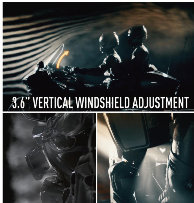
図4 エアマネジメント(上:風洞、下:ディフレクター)
