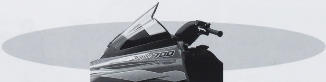
大型スクリーンを採用し、ウインドプロテクション効果をさらにアップさせた。
