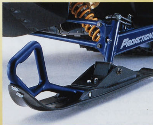
スキーに採用されるのは、98LTに共通のオールプラスチック。接地面の抵抗減少に優れ、なおかつ素材の持つしなりがサスペンション効果を生む。なお、サスペンションには97SXでも好評だったオーリンズのショックアブソーバーを採用。エンジンパフォーマンスを支える足廻りの要として重責を担っている。
