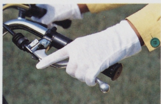
ブレーキ自体を固定する、確実に効きの良いロック式パーキングブレーキ。操作も手元でカンタンに行なえます。また、後輪には、耐久性の高いディスクブレーキを採用しています。
