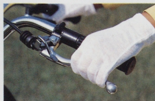
ブレーキ自体を固定する、確実に効きの良いロック式パーキングブレーキ。操作も手元でカンタンに行なえます。また、後輪には、耐久性の高いディスクブレーキを採用しています。
