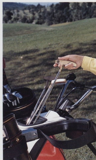
ハンドルのすぐ前にある大型パターケースは、乗車したまま取り出せるよう設計しています。また、カサ立てもスマートに配置しています。
