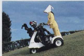
登坂能力20°と電気ブレーキによって、起伏の多いコースもラクラク走行。キャディさんの負担を軽減します。
