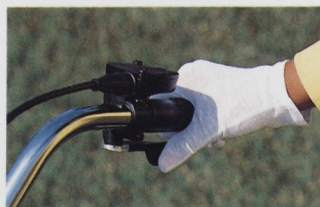
発進、速度調節が指先ひとつで行なえるレバー式アクセル。ゆるやか発進のスロースタート回路、ディファレンシャルギア。フェアウェイを守る3つの気ばりです。
