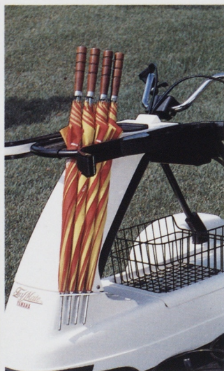
ハンドルのすぐ前にある大型パターケースは、乗車したまま取り出せるよう設計しています。また、カサ立てもスマートに配置しています。
