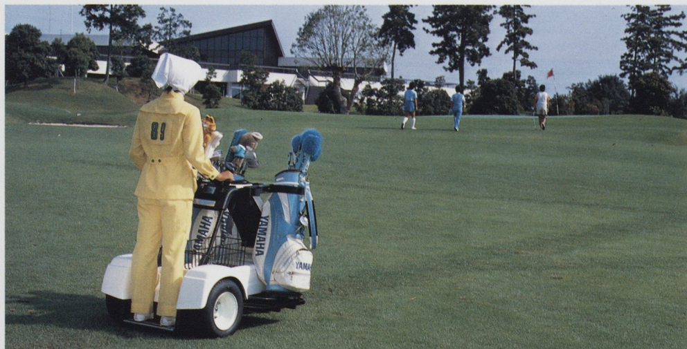
登坂能力20°と電気ブレーキによって、起伏の多いコースもラクラク走行。キャディさんの負担を軽減します。
