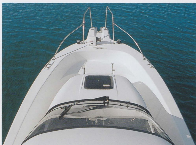
パウデッキ／2人分の釣りスペースを確保。余裕のスペースに200m (φ16mm)のアンカーロープを収納できる大型パウロッカーを装備。ハル一体型のパウスプリットがスタイリングを際立たせるとともに、スマートなアンカリングを実現します。
