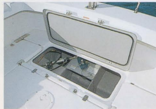
舵機室、プロペラ点検口
