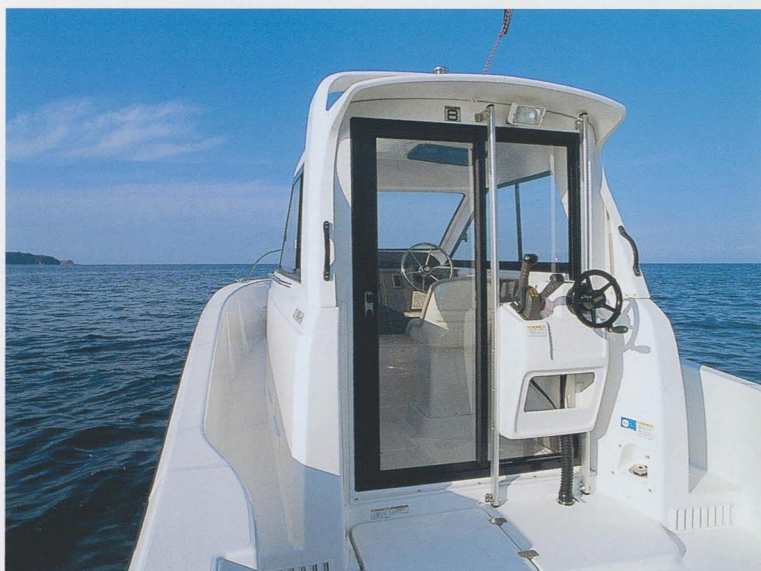
ウォークアラウンドデッキ／パウとスターン、デッキ間の移動を妨げないよう、通路幅を275mmと余裕のサイズに設定。スムーズな移動を実現します。
