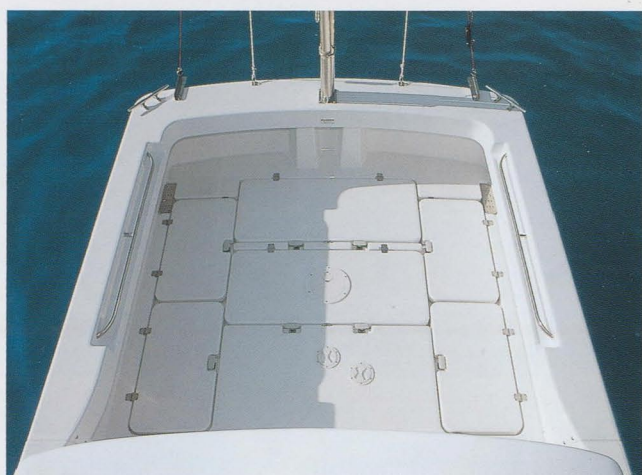
スターンデッキ／インボードタイプの特性を活かしたワイドでフラットなスターンデッキ。全長2,600mmというクラストップ*のスペースを確保し、4人同時に安心して釣りを楽しむことができます。また、オープンガンネルやデッキの要所に補強を施しているため後艀装も容易に行えます。*当社比
