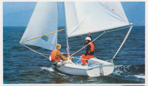
**ウィスカポール**…ランニングのと き、追風を効率よく受けるため、 メンスルとジブスルを観音開きに する。そのとき使うのがウィスカ ポール。
