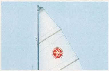
第 I バテンはFRP製のフルバテン。高い位置で風を有効につかみます。セールはテトロン製。風にも水にも強く、海水にぬれてもすぐ乾く材質です。
