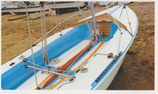
メインシートトラベラー装置,ブーム バング …風に応じて適切なセール セットができるトラベラー。クロー ズホールドのときでもランニングの ときでも常に効率の良いセーリング ができるブームバング。
