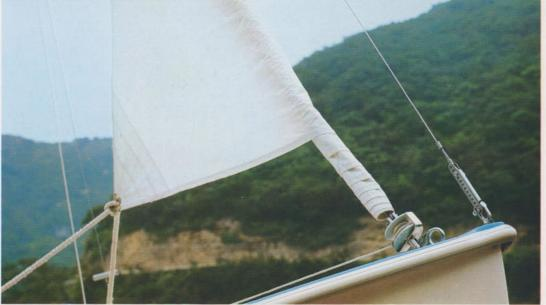
**ジブ・ローラー**…風が強いとき、 スピンを展開するときコックピッ トで、ロープ操作するだけでジブ スルがかんたんに巻きこめます。
